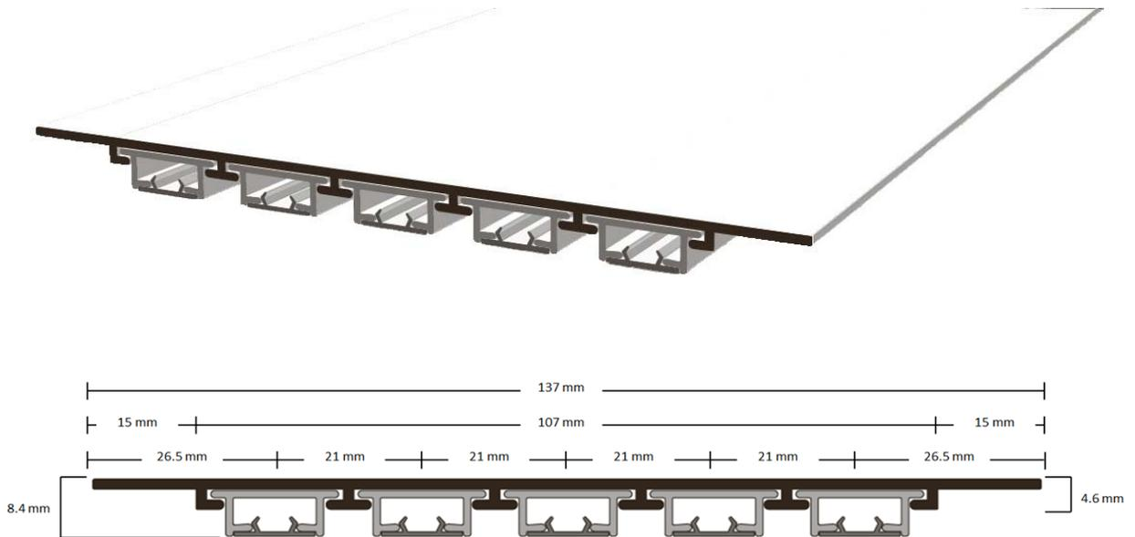
Flächenvorhangprofilssystem, bis fünfflüchtig frei wählbar, komplett mit Profil, Abdeckband eingelegt und Haftgrund behandelt zum eingipsen.
