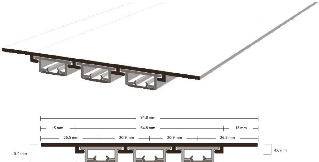
Flächenvorhangprofilssystem, bis dreiläufig frei wählbar, komplett mit Profil, Gipschutzband eingelegt und Haftgrund behandelt zum eingipsen.
